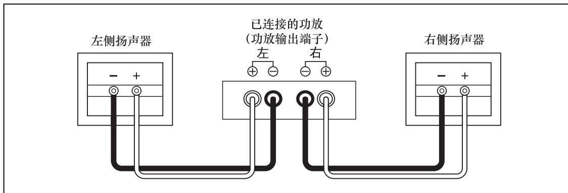
\* 如果左右扬声器的极性连接不正确，则再现音质、环境气氛和方向感将受到明显的影响。
